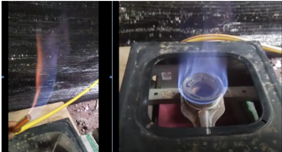
Gambar 5. Kompor berbahan bakar biogas
