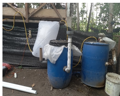
Gambar 4. Reaktor Biogas yang telah dipasang di dapur dan prototipe
