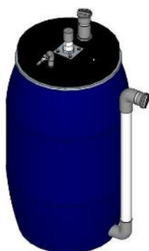
Gambar 4. Reaktor Biogas yang telah dipasang di dapur dan prototipe
