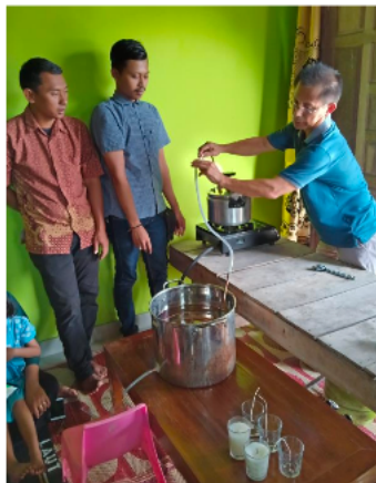
Gambar 2. Peragaan cara penyulingan/distilasi minyak atsiri tanaman serai menggunakan destilator mini
