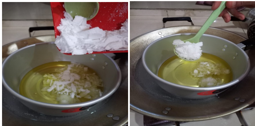
Gambar 3. Proses Pemanasan Parafin dengan Minyak Jelantah Dengan Cara Memanaskan Di Dalam Air (Tim)
